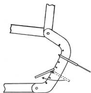
La dirección de tracción está determinada por la posición del gancho en J y la unidad del tubo en la placa frontal. Esta posición se puede cambiar fácilmente. El tubo se extrae girándolo 180° y luego sacando el gancho del tubo del ojo de la cerradura en la placa frontal.
